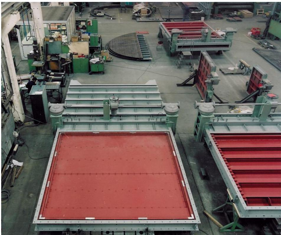
Die Abbildung zeigt 3, der insgesamt 6, für diesen Fall gelieferten Schieber während der Endmontage und den Probe-läufen im Werk Rauenstein.
