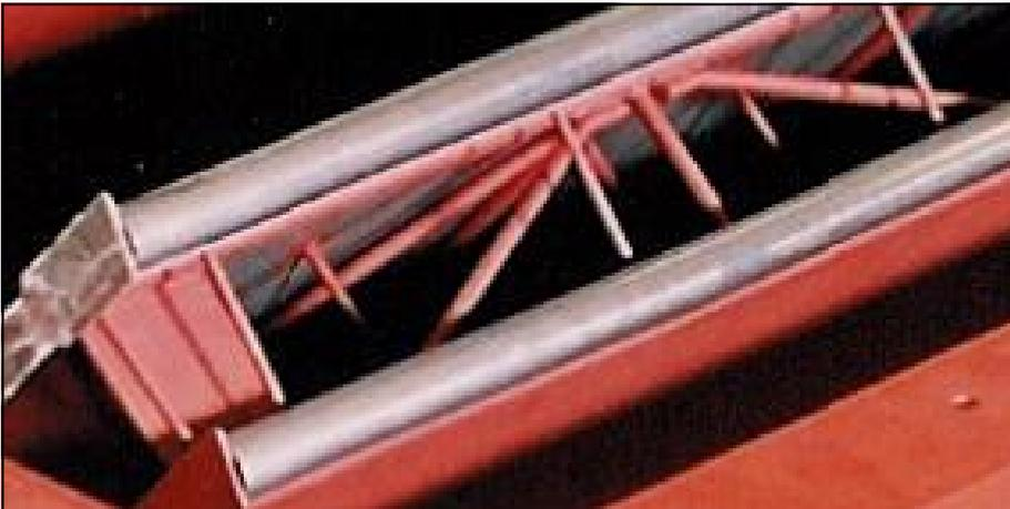
Der Gitter-Tragwerk-Flügel mit den frei beweglichen, kardanisch befestigten Flügelblechen ist auch bei hohen und rasch wechselnden Temperaturen frei von Wärmeverzug. Der Flügel wird von den Heißgasen ständig durchströmt, so dass sich alle Stäbe des Gitter-Tragwerkes gleichmäßig erwärmen.
