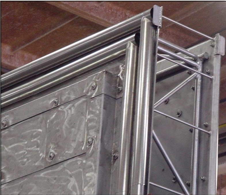
Der Gitter-Tragwerk-Flügel mit den frei beweglichen, kardanisch befestigten Flügelblechen ist auch bei hohen und rasch wechselnden Temperaturen frei von Wärmeverzug. Der Flügel wird von den Heißgasen ständig durchströmt, so dass sich alle Stäbe des Gitter-Tragwerkes gleichmäßig erwärmen.
