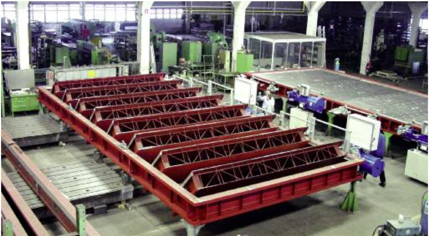
**RAUMAG-JANICH** lieferte für die REA des **Kraftwerkes Ninghai** in China 8 Tandem-Jalousieklappen NW 11.600 x 5.200 mm. Die Klappen werden mit pneumatischen Antrieben bewegt und haben eine Sicherheitsfunktion. Das Bild oben zeigt zwei Klappen bei den Probeläufen im Werk Rauenstein.
