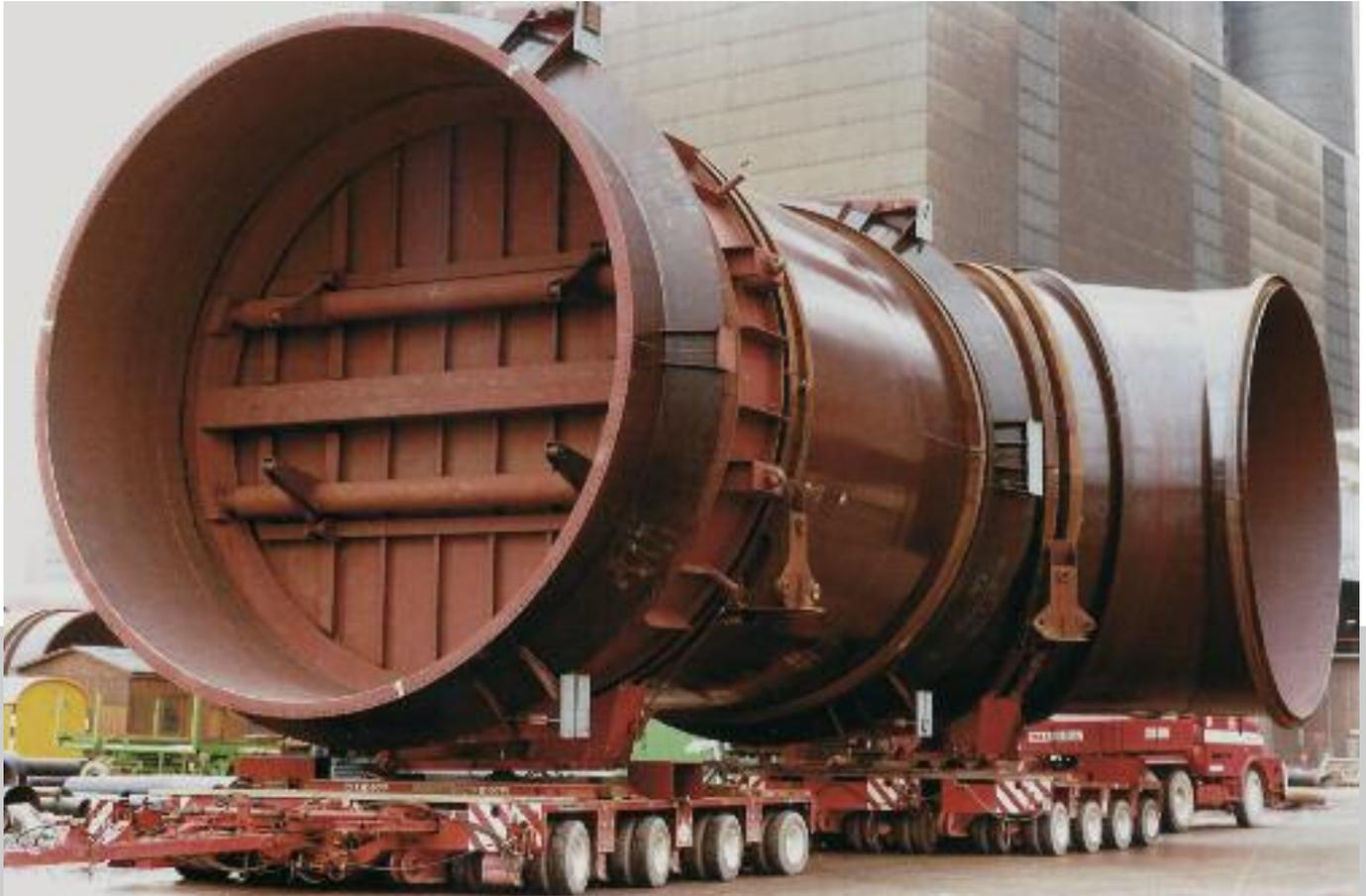
Bild oben: Schwenklappe DW 7000 mm mit Kanalstück beim Transport zum Einbauort.
