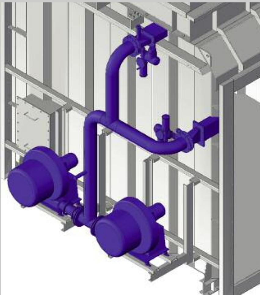
In Verbindung mit einer Doppeldichtung erreicht man durch die Einführung von Sperrluft zwischen die beiden Dichtebenen bei geschlossenem Klappenflügel eine 100% Absperrung des Heißgasstromes. Der Sperrluftdruck muss dabei über dem Druck des abzusperrenden Gases liegen.
